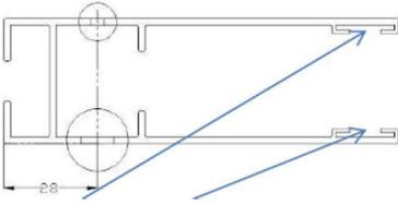
Ziehen Sie die Bürstendichtungen (20) in die dafür vorgesehenen Laschen im Führungsprofil ein und sichern diese durch Verpressen der Enden gegen Herausrutschen.
