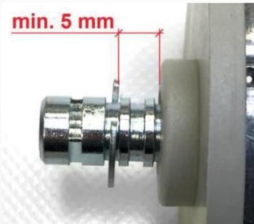
Schlagen Sie den Kunststoff-Lagerdeckel (3) vorsichtig in die Tuchwelle (5) ein. Montieren Sie die Sicherungsscheibe auf dem Lagerbolzen (siehe Bild). Wählen Sie dabei die Nut so, dass nach der Endmontage der Anlage zwischen Sicherungsscheibe und Kunststoff-Lagerdeckel mindestens ein Abstand von 5 mm besteht.
