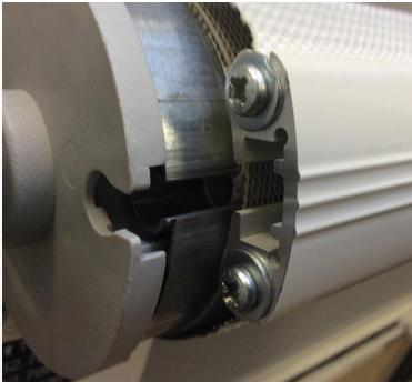
Zur Sicherung mittels Schraube empfehlen wir die Kederschnur des Fahnenkeders mit  $D=3$  mm vorzubohren und danach mit selbstschneidenden Schrauben  $4 \times 30$  und Unterlagscheibe  $D=14$ ,  $d=5$  (nicht im Lieferumfang enthalten) einzudrehen.
