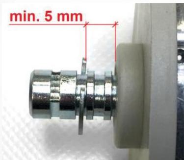
Schlagen Sie den Kunststoff-Lagerdeckel (3) vorsichtig in die Tuchwelle (5) ein. Montieren Sie die Sicherungsscheibe auf dem Lagerbolzen (siehe Bild). Wählen Sie dabei die Nut so, dass nach der Endmontage der Anlage zwischen Sicherungsscheibe und Kunststoff-Lagerdeckel mindestens ein Abstand von 5 mm besteht. Anschließend schieben Sie den Lager-Bolzen in den Kunststoff-Lagerdeckel (3).
