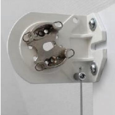
Befestigen Sie das Motor-Lager (15) mit den beiliegenden Schrauben M6 x 12 mm an der entsprechenden Konsole.
